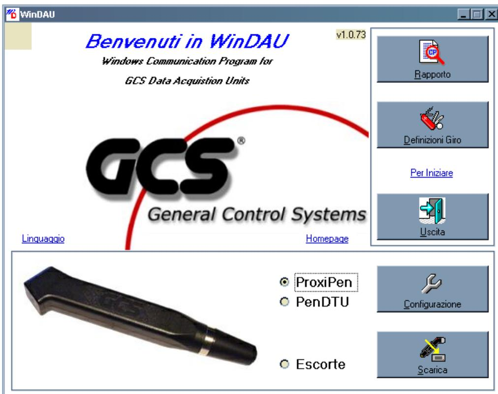
**Configurazione:** Visualizza ed imposta i parametri principali del ProxiPen (data/ora - stato batteria - tipo di batteria - stringa modem per la trasmissione remota - porta seriale e velocità di scarico - etc.)
